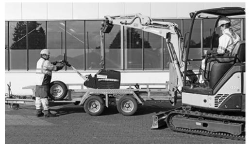
9 Aufladen der Maschine mit dem Bagger
