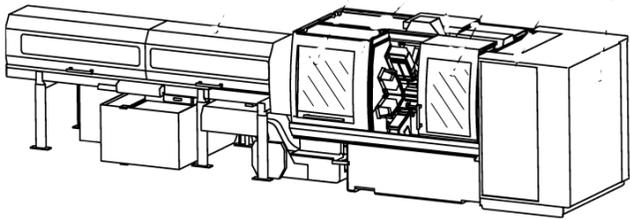
Source: EN ISO 23125; exemple d'une machine de tournage automatique monobroche à embarreur et à commande numérique avec un deuxième chariot pour les contre-broches du groupe 4
