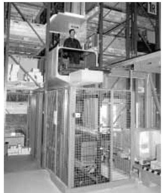
Bild 2: Handgesteuertes Regalbediengerät. Der Zugang zum Gerät und die Materialübergabestelle sind gesichert.
