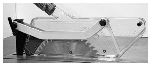
3 Couteau diviseur équipé d'une cape de protection
