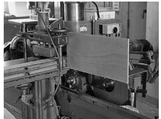
Bild 2: Beispiel einer Verdeckung am Schiebetisch.
