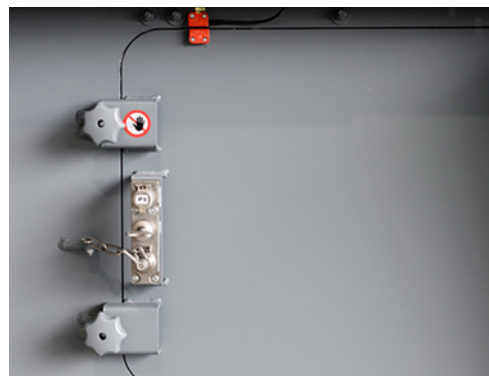
4 Porte d'accès avec interrupteur de surveillance et système d'interverrouillage à clé captive interdisant le redémarrage de la machine par un tiers
