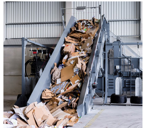
2 Presse à balles équipée d'un transpondeur (dispositif de détection sensible) au-dessus du convoyeur
