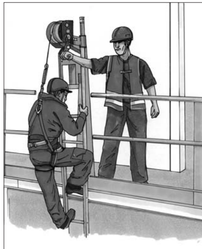
12 Siloeinstieg mittels Leiter. Nur zulässig in Kombination mit einem Höhensicherungsgerät mit Rettungseinrichtung.
