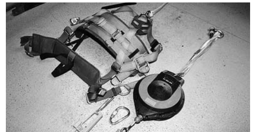
10 Auffanggurt, Hilfsmittel (Karabiner usw.) und Höhensicherungsgerät mit Hochziehkurbel für die Rettung.
