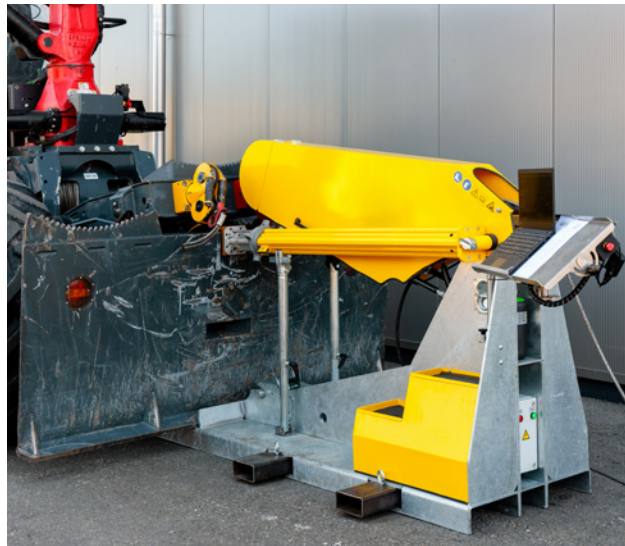
1 Banc d'essai de treuil pour le mesurage des forces de traction et de freinage exercées sur le treuil.
