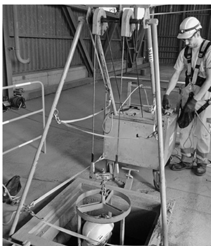
11 Accesso al silo tramite apparecchio per la discesa (argano) con cesta portapersona. Questa unità deve avere la conformità CE come insieme.
