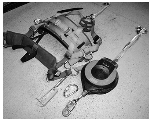
10 Imbracatura anticaduta, ausili (moschettone ecc.) e dispositivo anticaduta di tipo retrattile con manovella per la risalita di salvataggio.
