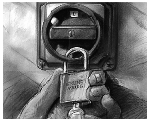
8 Interruttore di sicurezza lucchettabile in posizione zero.
