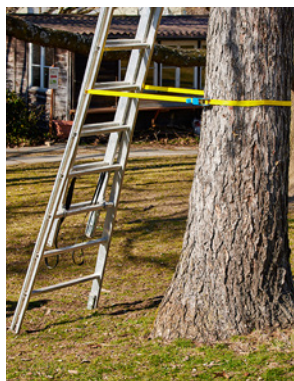
1 Messa in sicurezza della scala con cinghia di fissaggio intorno alla base del tronco
