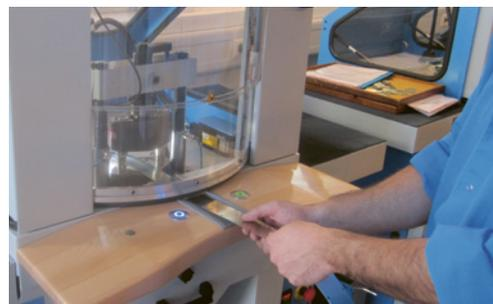
3 Tranciatura di strisce di lamiera con utensile schermato. Il nastro di lamiera viene inserito tramite una fessura. Sarebbe possibile usare anche una barriera immateriale di tipo «floating blanking» (a risoluzione ridotta).
