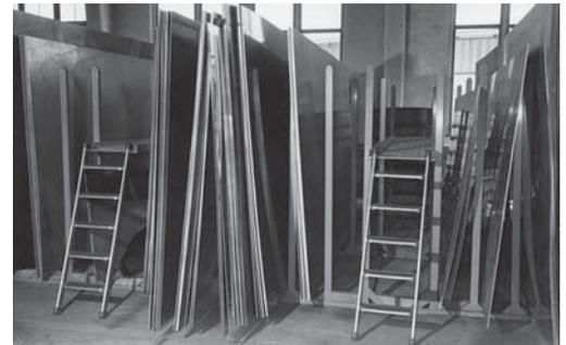
Bild 2: Vertikal gelagerte Bleche in Gestellen mit Bedienungsbrücke.
