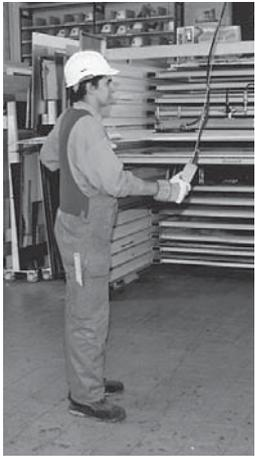
Bild 8: Die persönliche Schutzausrüstung (Handschuhe, Schutzschuhe, Schutzhelm) und der Einsatz geeigneter Hilfsmittel reduzieren das Unfallrisiko.
