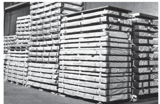
Bild 5: Werden Distanzhölzer den Blechpaketen angebracht, kann man diese mit einem Gabelstapler leicht abtransportieren.
