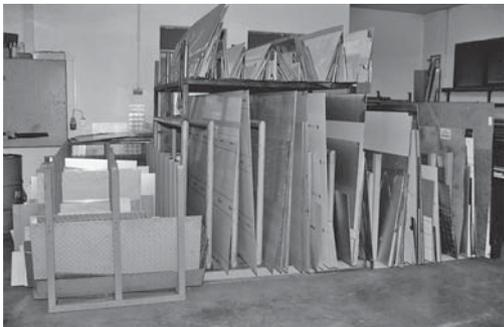
Bild 6: Lagergestelle für ganze Bleche und Restbleche.
