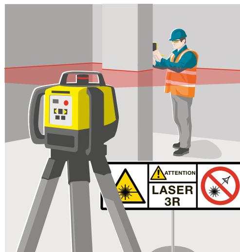
5 Étiquetage d'un local où sont utilisés des lasers de classe 3R
