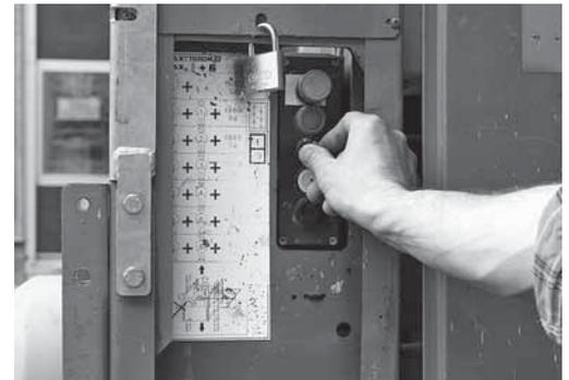
Fig. 5: unité de commande sur la plateforme
