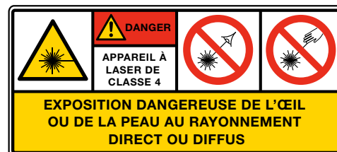
1 Classification, plaque d'avertissement «Appareil à laser de classe 4» et plaque indicatrice selon la norme SN EN 60825-1
