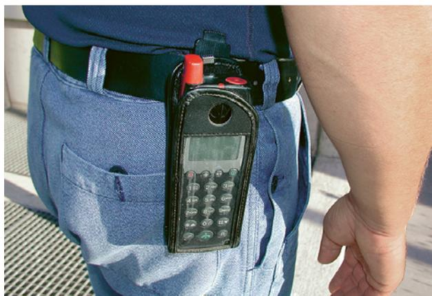
34 Récepteur d'un téléphone sans fil équipé d'une alarme individuelle, ce qui suppose l'existence d'une organisation d'alerte appropriée.
