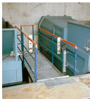
17 Benne à portique (WELAKI) sécurisée et aisément accessible des deux côtés, d'où un accrochage et un décrochage facilités des câbles.
