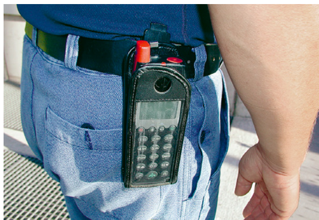
34 Récepteur d'un téléphone sans fil équipé d'une alarme individuelle, ce qui suppose l'existence d'une organisation d'alerte appropriée.
