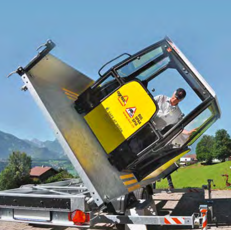
Der Überschlagssimulator für Traktoren zeigt auf, welche Kräfte bei einem Traktorsturz auf den Körper einwirken.
