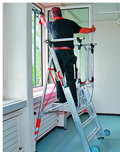
25 Le scale mobili con piattaforma possono essere impiegate, secondo le indicazioni del fabbricante, anche con altezze maggiori di 2 metri (superficie di appoggio).
