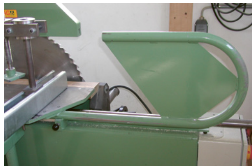
6 Exemple de couverture.
