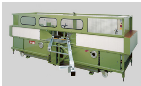
1 Depuis 1997, une enceinte de sécurité empêche tout accès aux machines.
