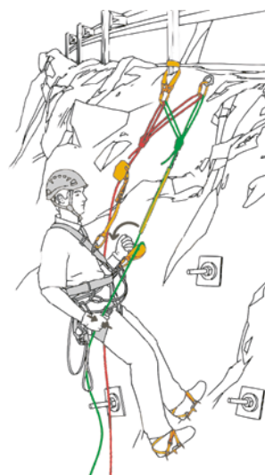
2 Sistema ridondante tramite l'ancoraggio indipendente del sistema di lavoro e del sistema di sicurezza
