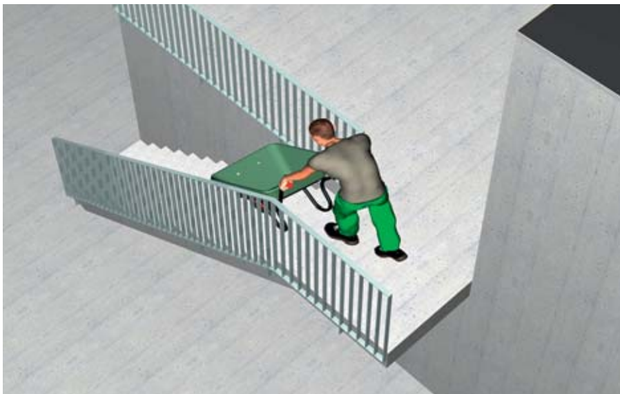
01 // Auf der Rückseite des Treppenpodests fehlte eine Absturzschutzgitter. Dies hatte für einen Arbeiter tödliche Folgen. // Suva
