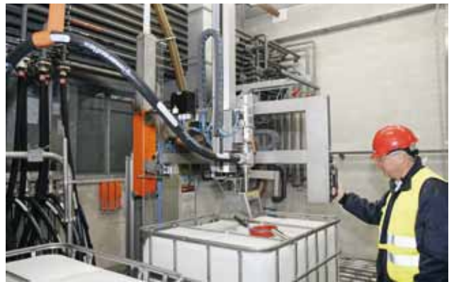
18 Halbautomatische Fass-Abfüllstation mit Absaugvorrichtung an der Austrittsstelle
