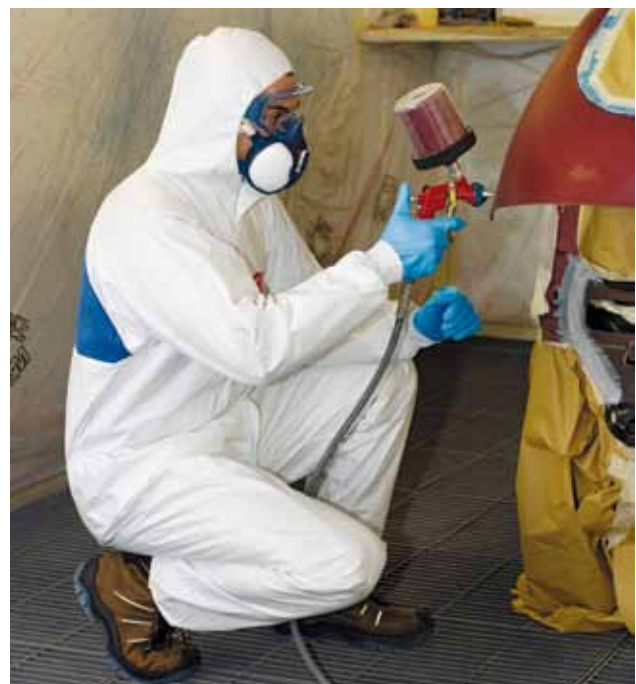
14 Aufsprühen von wasserlöslicher Farbe
