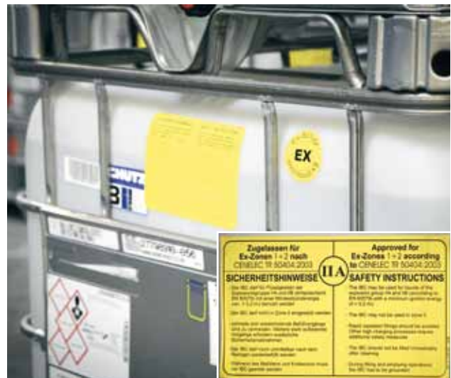
25 IBC-Behälter aus leitfähigem Kunststoff für die Verwendung in den Zonen 1 und 2
