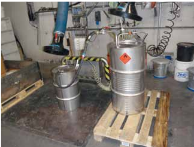
26 Erdung von Behältern (Umfüllen von Lösemittel mit Stickstoffüberdruck)
