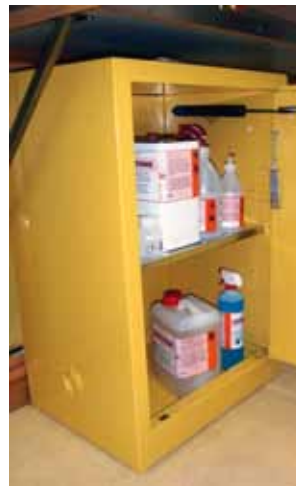
21 Schrank zum Aufbewahren von kleineren Mengen leicht brennbarer Flüssigkeiten in Arbeitsräumen.
