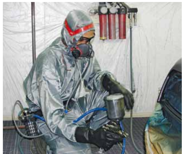
4 Arbeiten mit einer Farbspritzpistole und einem von der Umgebungsluft unabhängigen Atemschutzgerät
