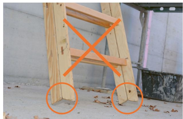
26 Wird die Stehleiter als Anstelleiter verwendet, steht sie nur auf der Kante der Leiterfüsse.
