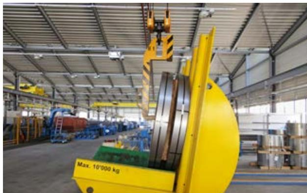
Fig. 9: per una rotazione sicura dei coil di 90° si consiglia di utilizzare delle attrezzature come i tavoli di rotazione.
