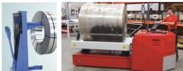
Fig. 7 e 8: utilizzando speciali carrelli ed elevatori per coil è possibile trasportare in sicurezza sia coil che nastri di acciaio in orizzontale.
