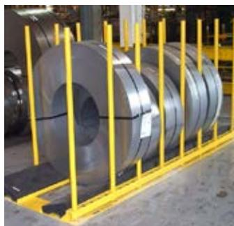
Fig. 3 con una rastrelliera si evita il ribaltamento dei nastri di acciaio
