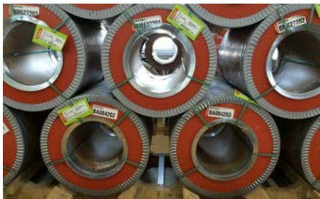
Fig. 1 con il sistema dei cassoni, è possibile accatastare in sicurezza anche diversi strati di coil.
