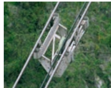
Nach einer Bahnstörung inspiziert die Drohne unter anderem die Aufhängungen für das Zugseil.
