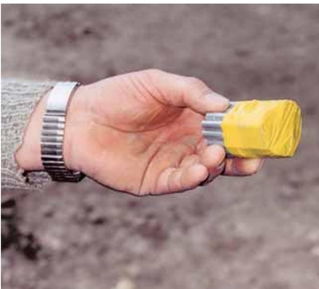
**Bild 1:** Die Öffnung der Sprengkapsel ist mit Klebband verschlossen.
