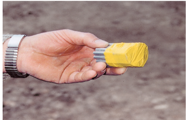
1 Die Öffnung der Sprengkapsel ist mit Klebeband verschlossen.
