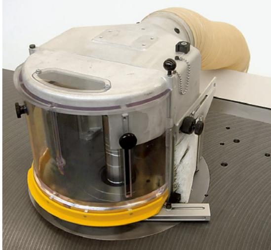
**Le protecteur pour moulurage de pièces cintrées permet un usinage sûr et économique.**
