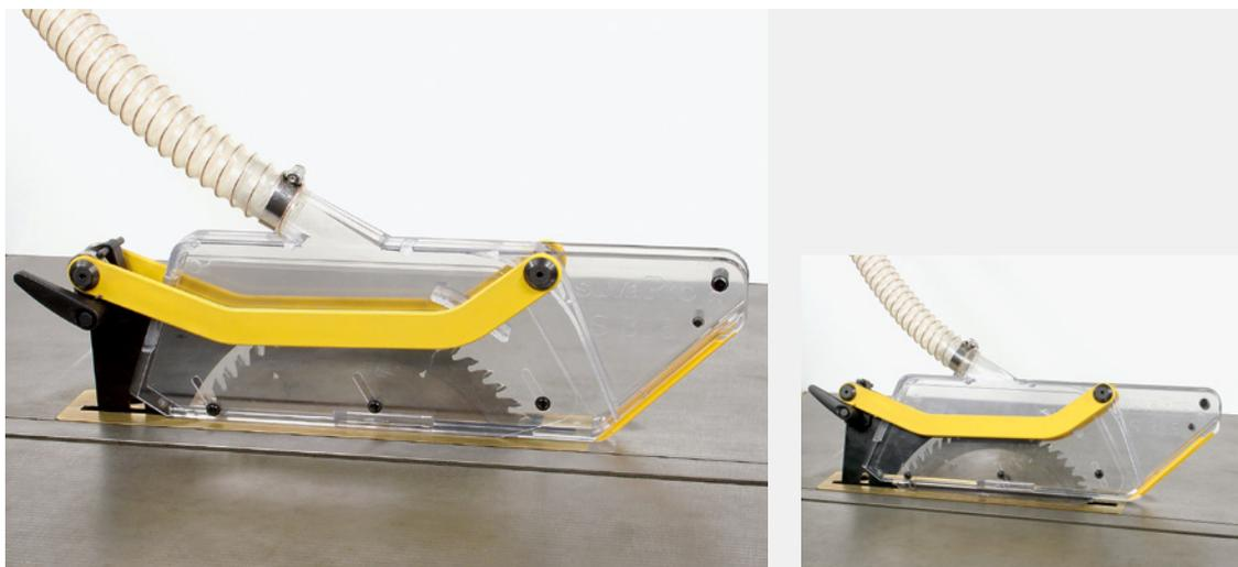
La cape de protection et d'aspiration S 315 se fixe sur le couteau diviseur. Elle recouvre entièrement la lame et la pièce usinée. Dotée d'un tuyau de 38 mm de diamètre intérieur, elle se raccorde aisément au dispositif d'aspiration des copeaux.
