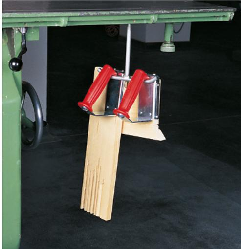
Ce crochet double est particulièrement utile pour suspendre des poussoirs. Il permet, par exemple, d'accrocher un poussoir longitudinal et un poussoir latéral à une scie circulaire à table. Cet accessoire se fixe sur la table de la machine ( taraudage M10).
