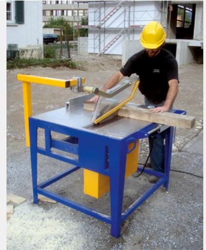
La cape de protection B 90 mise au point par des spécialistes de la prévention des accidents de la Suva et des professionnels du bâtiment a permis d'obtenir une nette réduction de la fréquence des accidents liés à l'utilisation de scies circulaires de chantier.
