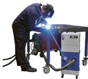
3 Chalumeau avec système d'aspiration intégré
