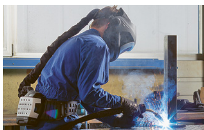
1 Casque de soudeur avec système filtrant à ventilation assistée
