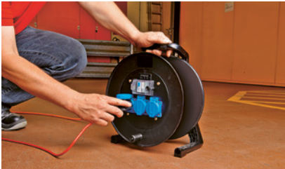
1 Kabelrolle mit FI-Schutz
