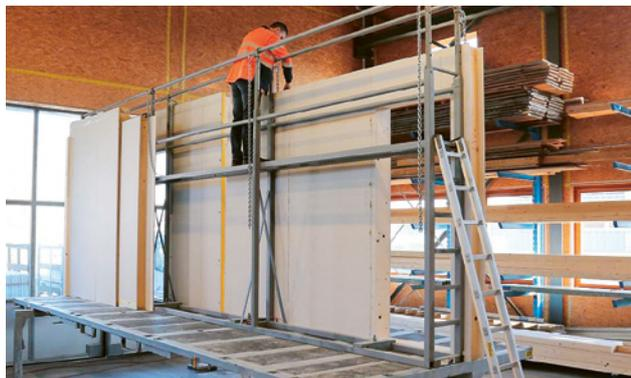
3 Système de plateaux interchangeables avec passerelle intégrée.
