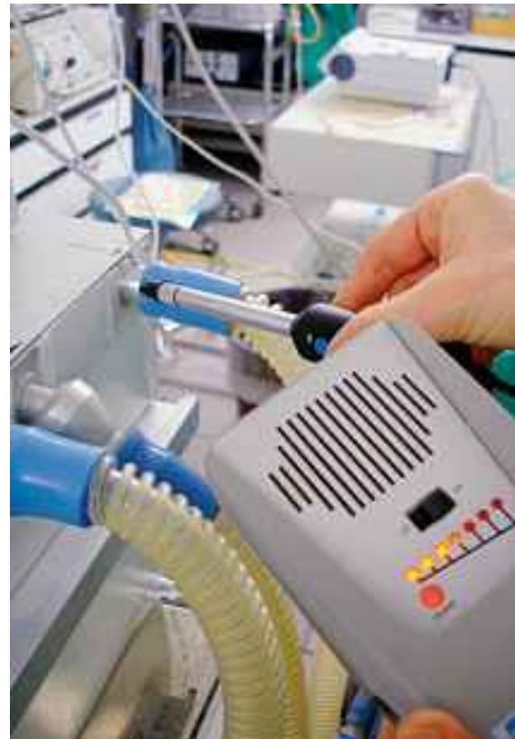
Gas anestetico – Monitoraggio di eventuali perdite in sala operatoria
