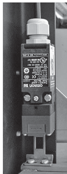
Fig. 2: un interruttore ad apertura forzata disattiva la lampada UV oppure chiude il suo diaframma non appena l'impianto viene aperto.
