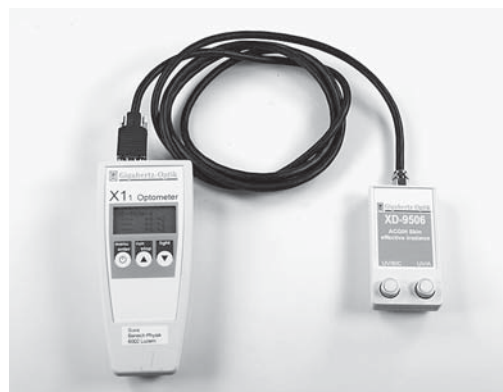
Fig. 3: per misurare la densità di potenza si utilizza un optometro calibrato.
