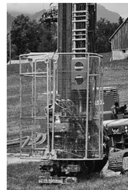
Fig. 4: les foreuses mises sur le marché dès le 10.3.2015 doivent être équipées de protections enveloppantes, p. ex. des cages métalliques.
