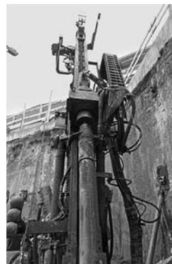
Fig. 3: les foreuses mises sur le marché avant le 10.3.2015 doivent être équipées de dispositifs sensibles des deux côtés du train de tiges, p. ex. au moyen de câbles de sécurité.
