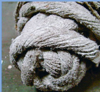
Cordons en amiante
