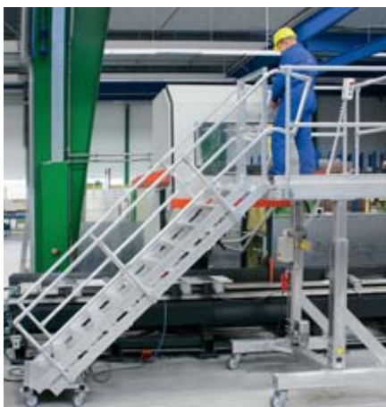
02 // Pedana di lavoro mobile. Quando si presenta un guasto o un problema di funzionamento, deve essere possibile accedere all'impianto in sicurezza, ad esempio con una pedana di questo tipo.
