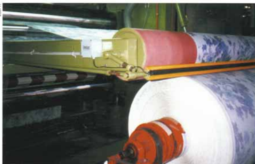
Figure 35: Rouleau indépendant de la calandre dans une entreprise d'ennoblissement des tissus. La zone d'engagement entre le cylindre d'étirage (2) et le rouleau grand diamètre (3) est protégée, dans les conditions de service normal et particulier, par une barre sensible combinée à une liste sensible (1). Lorsqu'on entre en contact avec la liste sensible, le cylindre entraîneur est arrêté et soulevé automatiquement du rouleau grand diamètre.
