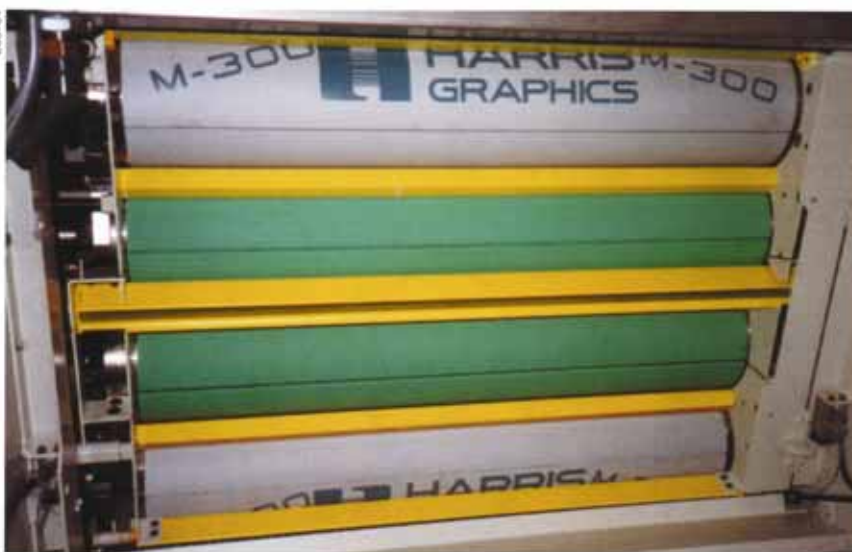
Figure 19: Rotative pour l'impression offset. Les zones d'introduction des cylindres ou rouleaux doivent être protégées par des barres de protection à la fois dans les conditions de service normal et particulier.
