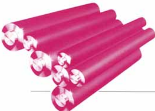
Figure 6: Paire de cylindres séparés par un intervalle maximal de 120 mm. La vitesse circonférentielle de l'un des deux cylindres ( V_1 ) est supérieure à celle de l'autre ( V_2 ). Il y a danger d'entraînement des doigts, des mains et des bras.
