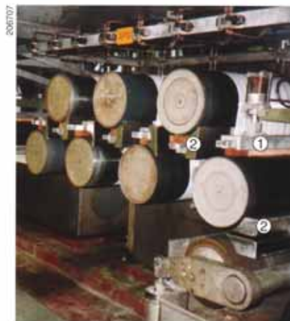
Figure 22: Trains de laminoirs pour fibres dans une entreprise de fabrication de fibres chimiques.
