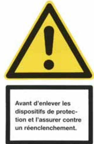
Figure 47: Mise en garde contre le danger d'entraînement lorsque les protecteurs fixes doivent être enlevés pour effectuer des travaux de maintenance (signal d'avertissement, réf. 1729/33, signal supplémentaire, réf. 1729/39.f).
