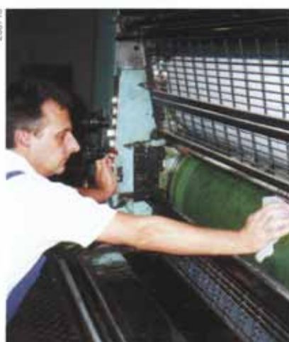
Figure 36: Rotative pour l'impression offset. Dans les conditions de service particulier, le capot de protection est ouvert. Le fonctionnement de la machine répond uniquement à la commande de marche par à-coups, à une vitesse réduite (commande de marche par à-coups = dispositif de commande qui n'autorise qu'une marche limitée). Tout contact avec la barre sensible (1) entraîne l'immobilisation immédiate des cylindres.
