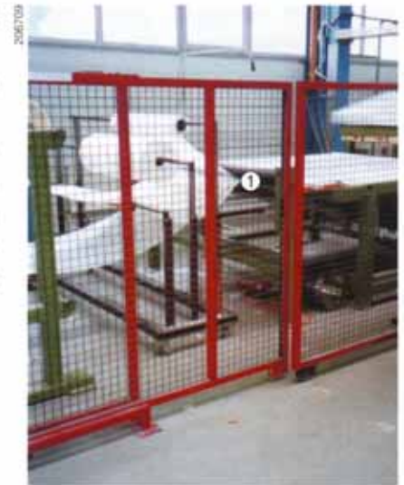
Figure 25: Laminoir de matières plastiques. Les zones dangereuses de toutes les pièces en mouvement et la zone d'entraînement des cylindres dérouleurs (1) sont protégées, dans les conditions de service normal, par un grillage et une «porte d'accès» verrouillée (protecteur avec dispositif de verrouillage).
