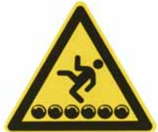
Figure 48: Mise en garde contre le franchissement de cylindres et de rouleaux, réf. 1729/70.
