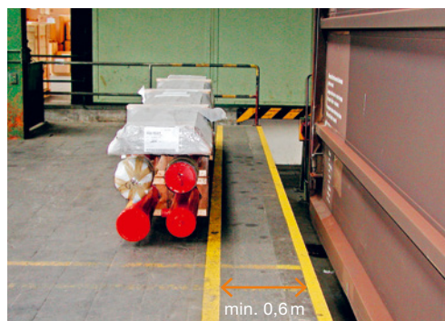
2 Area di sicurezza su una rampa di carico e segnalazione della zona con rischio di caduta.
