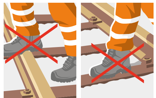
4 Attraversamento in sicurezza dei binari.
