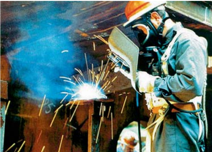
Abb. 4 oben: Schweißer mit einem Gebläsefiltergerät mit Schweißhelm und kombiniertem Gas- und Partikelfilter; unten: Schweißer mit einem von der Umgebungsluft unabhängigen Schlauchgerät für den Einsatz in engen Räumen.
