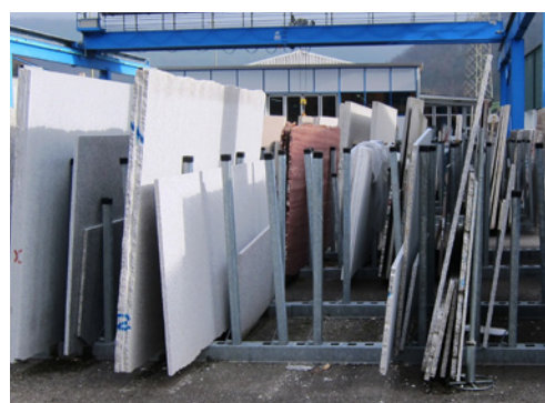
2 Rastrelliera con sostegni verticali per lo stoccaggio in sicurezza delle lastre
