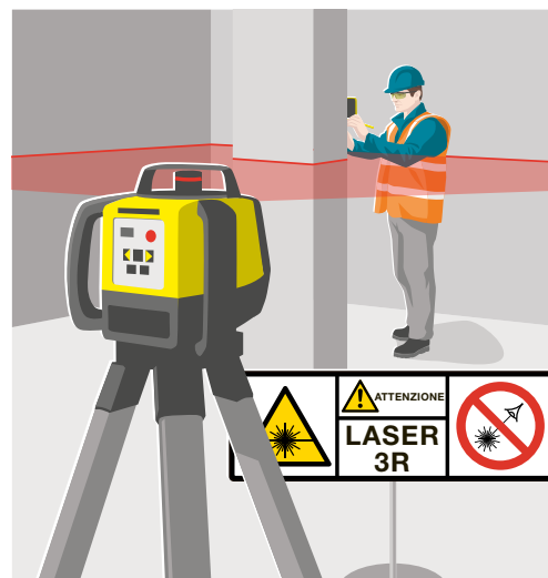
5 Segnalazione di un ambiente in cui viene impiegato un laser di classe 3R.
