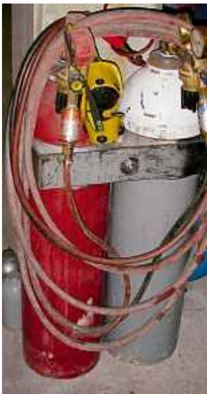
Figura 7: acetilene e ossigeno, componenti della saldatura autogena
