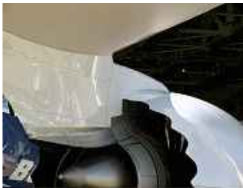
Minore rumorosità grazie alla forma a dente di sega del bordo della carena del motore (Boeing 787).
