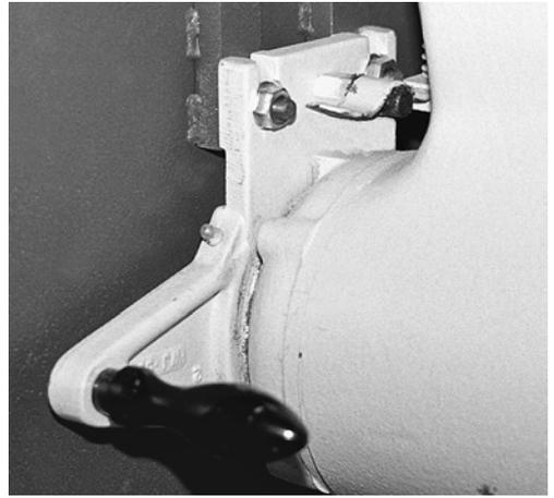
1 Isolierter Handgriff und Festhaltevorrichtung für das Sägeblatt in der Ausgangsstellung (Blattfeder und Bolzen).
