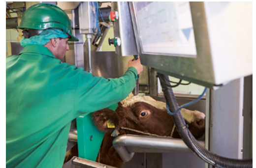
Figura 2: immobilizzazione adeguata dell'animale nella fase di stordimento
