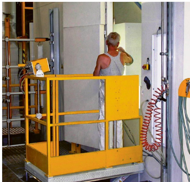
5 Questa piattaforma elevabile a forbice può raggiungere un'altezza massima di 1 m. Qualora l'operatore dovesse per sbaglio fare un passo indietro, il parapetto gli impedirebbe di cadere giù. In base alle caratteristiche del luogo di lavoro potrebbe essere necessario installare un parapetto anche a un'altezza inferiore a 500 mm.
