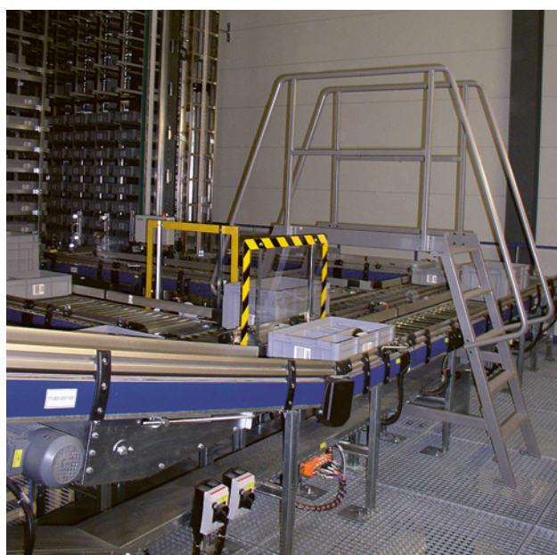
6 I parapetti su entrambi i lati della passerella proteggono efficacemente persone e oggetti dalla caduta all'interno del trasportatore automatico. Anche le scale a castello sono dotate di corrimano su entrambi i lati.
