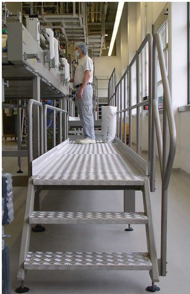
4 La plateforme de contrôle le long de l'installation de transformation est sécurisée des deux côtés par un garde-corps. Cette sécurisation est obligatoire, car la hauteur de chute dépasse 500 mm.
