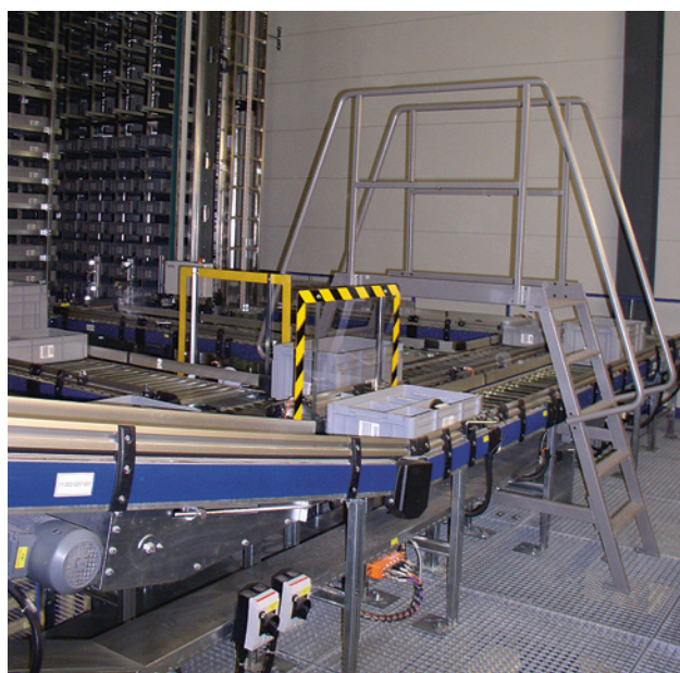
6 Passerelle sécurisée latéralement par deux garde-corps. Cela empêche efficacement toute chute d'objets ou de personnes sur le convoyeur automatique. Les marches d'accès sont sécurisées par une main courante des deux côtés.
