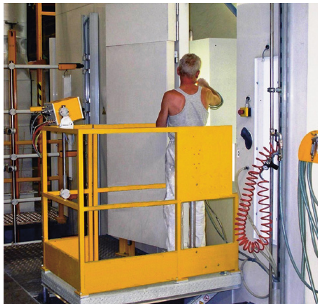
5 Cette plateforme élévatrice a une hauteur maximale de levage de 1 m. Le garde-corps protège l'opérateur des chutes (p. ex. en cas de faux pas en arrière) quelle que soit la hauteur du pont. Il arrive que les conditions de travail rendent obligatoire l'installation d'un garde-corps à une hauteur de chute inférieure à 500 mm.
