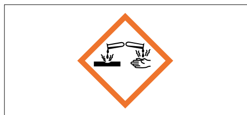
2 Le symbole de danger «corrosif» signale la présence d'un risque cutané important. Des mesures de protection de la peau, telles que le port d'équipements de protection appropriés (p. ex. gants), doivent être impérativement respectées.
