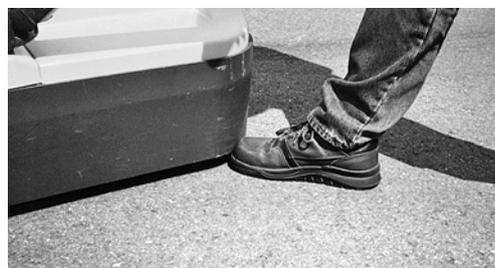
3 Con uno spazio minimo tra il bordo del telaio e il pavimento (massimo 35 mm) e l'uso di calzature di sicurezza i piedi risultano più protetti.
