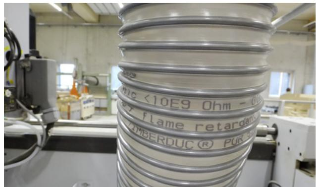
17 Tuyau antistatique, difficilement inflammable (PUR) (source: von Rohr Holzbau AG)
