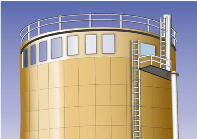
4 Décharge de la pression d'explosion avec disques de rupture (source: Deutsche Berufsgenossenschaft Holz und Metall, BGHM)
